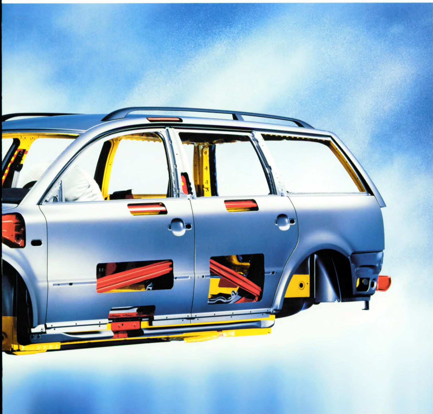
Geprogrammeerde deformatie bij frontale botsing.
