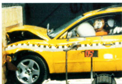
Geprogrammeerde deformatie bij frontale botsing.
