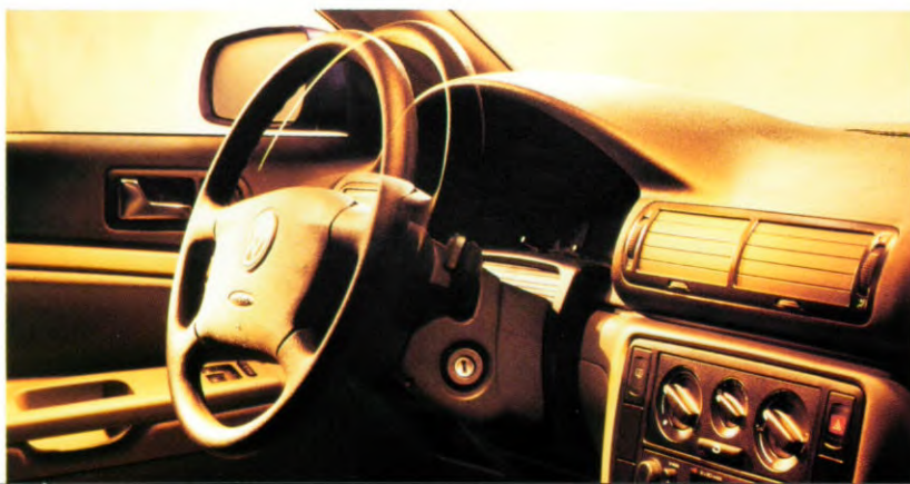
Het veiligheidsstuurwiel met airbag; in hoogte en lengterichting verstel- baar. (Radio niet standaard.)
