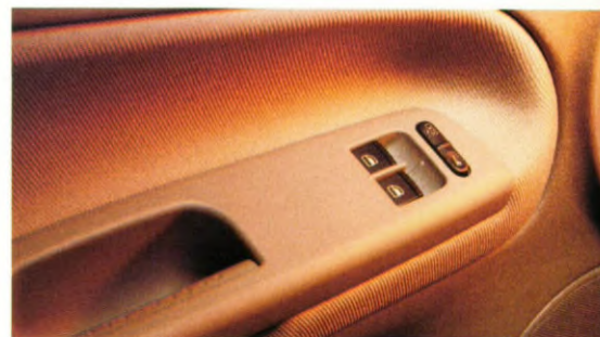
Elektrische ruitbediening vóór, met klembeveiliging.
