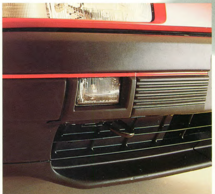
De dwarsgeplaatste motor maakt een relatief korte en vlakke motorkap mogelijk. De koellucht wordt onder de voorbumper aangezogen.
