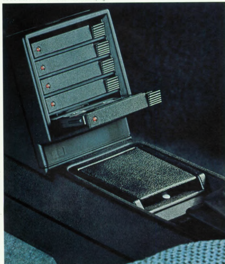
Het cassetteopbergvak met spoelvergrendeling en inhoudsopgave.
