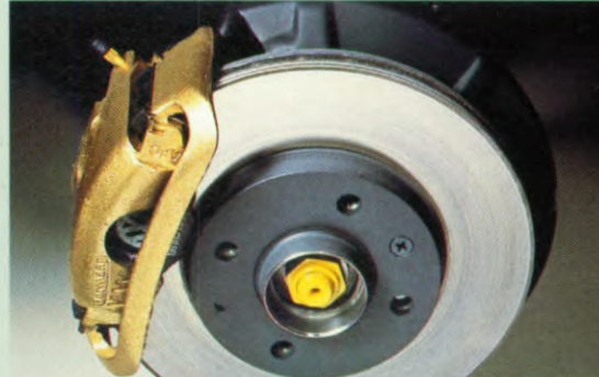
De van binnen uit geventileerde remschijf van de 5-cil. modellen.
