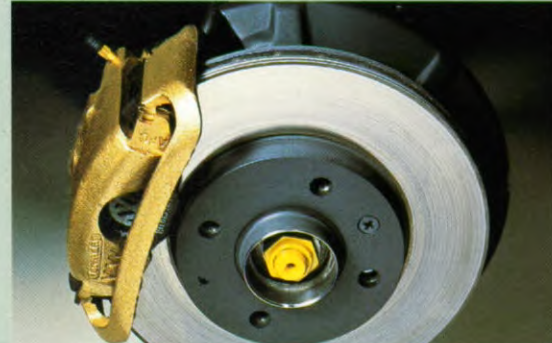
De van binnenuit geventileerde remschijf van de 5-cil. modellen.
