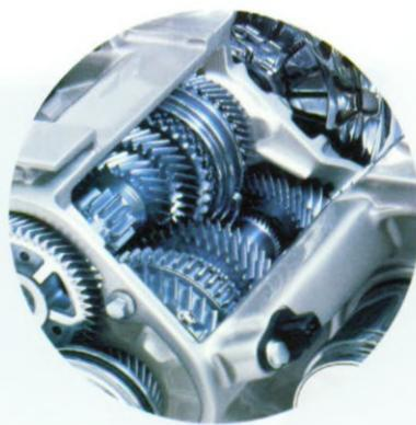
**Leichtgewicht:** das Direktschaltgetriebe mit Aluminiumgehäuse.
