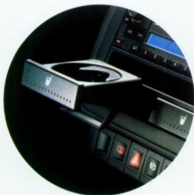
**Ausklappbar:** zwei Becherhalter in der Armaturentafel.
