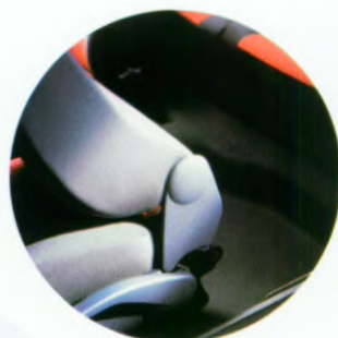
'Easy-entry': de zitting glijdt bij het vooroverklappen van de rugleuning ver naar voren, waardoor instappen comfortabeler wordt (meeruitvoering).
