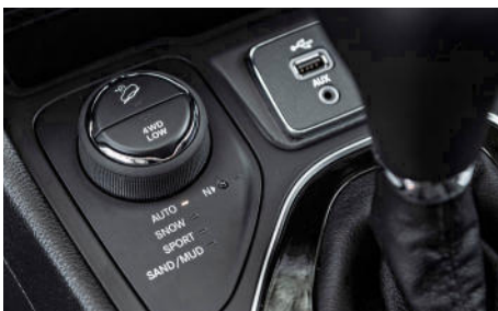
▲ De keurig afgewerkte bagageruimte groeide naar 570 liter. ▼ Met deze knop stel je de verschillende standen van het 4WD-systeem in.
