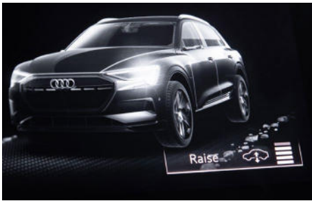
▲ In de offroad-modus wordt er aan de bodemvrijheid van 17,2 cm vijf centimeter toegevoegd.
